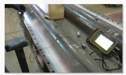
Ультразвуковой контроль гребёнок с коллектором
