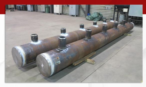
ПРОИЗВОДСТВО ТРУБОПРОВОДОВ Коллектор трубной обвязки в сборе
