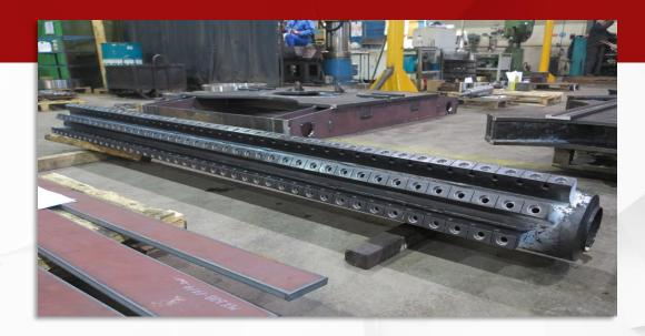
**ИСПОЛНЕНИЕ** Коллекторы с гребенками, традиционная конструкция, методы контроля: МТ, РТ и UT
