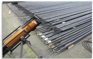
Рентген сварных соединений теплообменных труб и калачей
